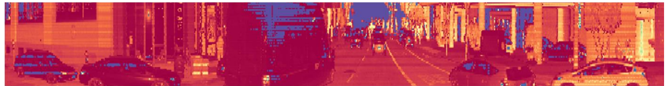
(d) Intensity of LiDAR points in range image I
